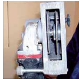
Spezial-Schlitzfräse mit zwei Diamant-Trennscheiben und verstellbarer Schnittbreite und -tiefe.
